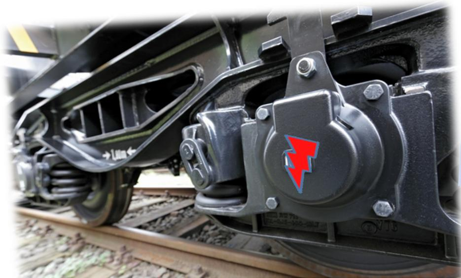
Sollte der LLZ einmal nicht mehr ausgelesen werden können, weil die Batterie bereits leer ist oder ein anderer Defekt auftrat, muss die Einheit mit Lagerdeckel, im Austausch gegen eine Neue zu Kaminski geschickt werden.
